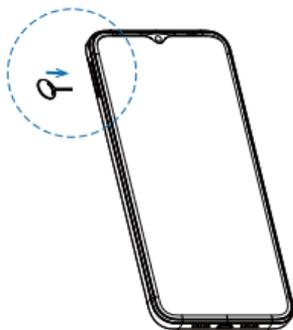
2. Retire la bandeja y coloque las Tarjetas nano-SIM y microSDXC (opcional) sobre la bandeja como muestra la figura. Reinserte la bandeja cuidadosamente.
