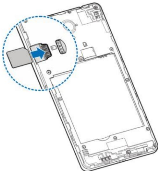
3. 3. Sostenga su tarjeta microSDXC con los contactos metálicos hacia abajo y deslícela en la ranura de tarjeta microSDXC.
